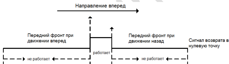
Рис. 1. Схема выбора источника сигнала и фронта сигнала
